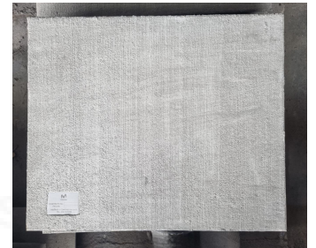
TAPA CONCRETO CAMARA F1 Y 2F1
